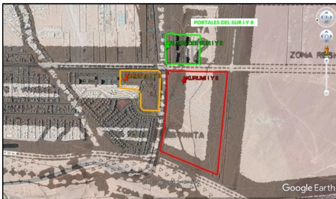
Imagen N°4: Superposición Plano Zonificación y Plano de Vialidad Plan Seccional Alto Hospicio- Alto Molle sobre Google Earth. En Línea segmentada amarilla se grafica el trazado de la vía V.T.A.M. 2 (Av. Las Américas) del Plano de Zonificación, en línea segmentada roja se grafica el trazado de vía V.T.A.M. 2 (Av. Las Américas) del Plano de Vialidad.
